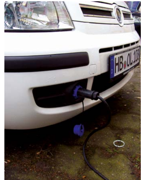
Zum Wiederaufladen der Batterien am Stromnetz angeschlossen / »Refuelling«, i. e. recharging the batteries
