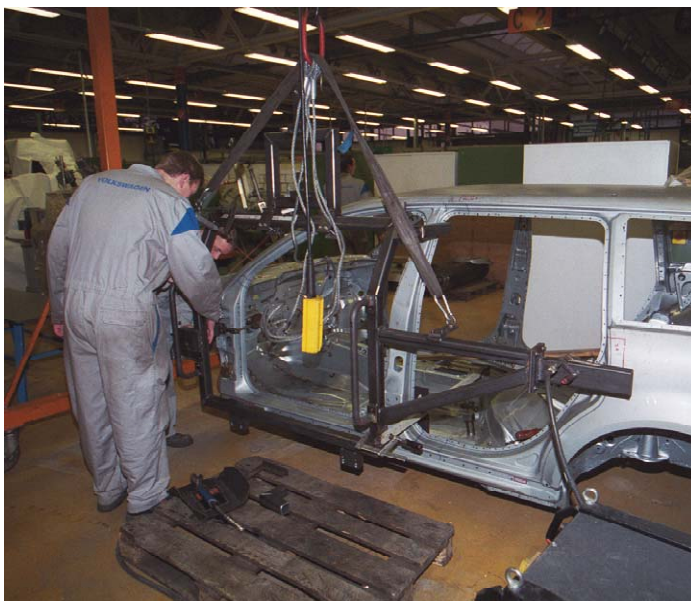
Abbildung 7: Anpassung des Träger-Rahmens der Vorrichtung an die Rohkarosserie (linkes Bild), Feinjustierung der Vorrichtung an der Vorderseite der Karosserie (rechtes Bild)
